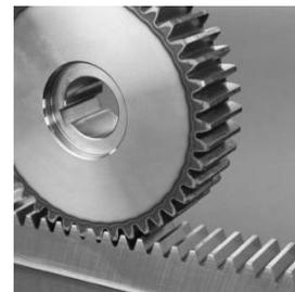
Ici aussi, la géométrie des dents assure un roulement sans glissement entre le cercle de diamètre primitif de la roue dentée et une ligne primitive de la crémaillère, les dents permettant de transmettre des efforts bien plus importants que par adhérence.
